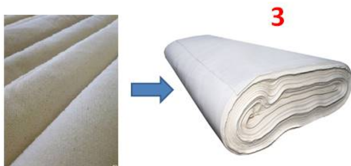
Полотно отбеливают и добавляют различные смолы и пигменты
