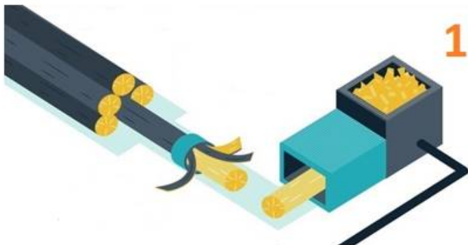
Древесину распиливают дисковыми пилами, очищают от коры и перемалывают в щепки
